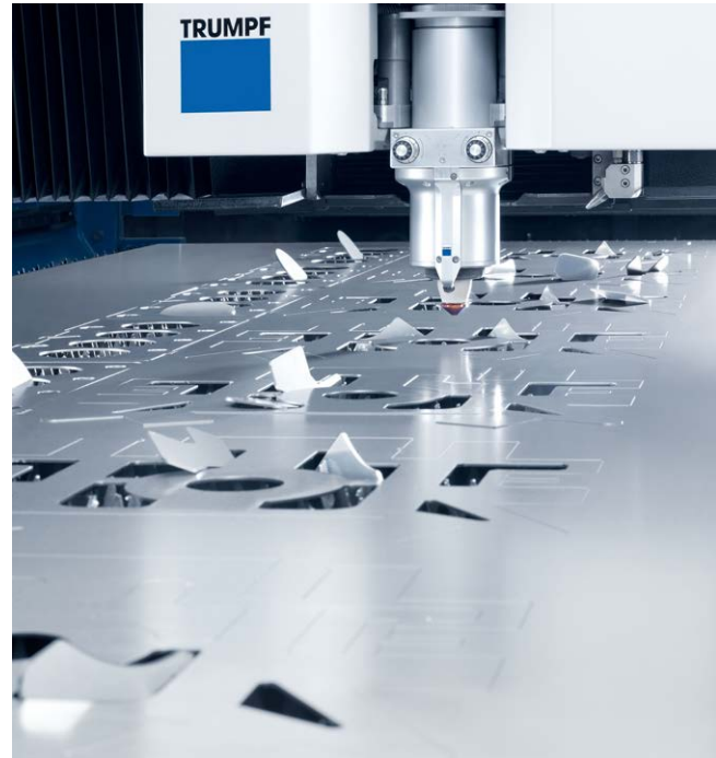
Abbildung 7: Verkippte oder durch das Restgitter gefallene Teile
