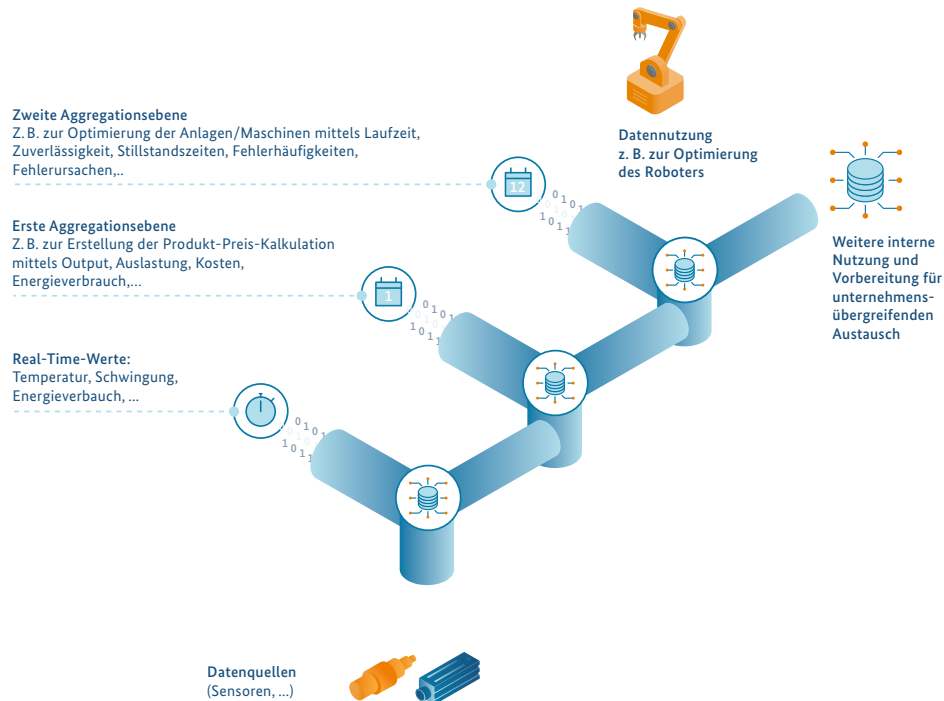
Abbildung 8: Y-Weiche – Anwendungsspezifische Aggregation der Datenströme
