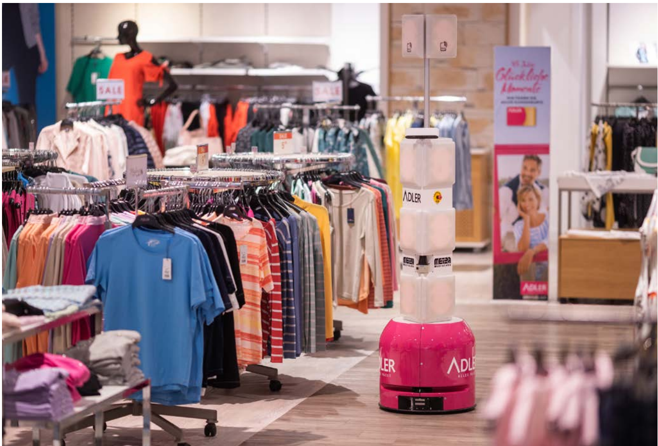
Automatisierte Inventur in Adler-Modemärkten mit TORY von MetraLabs
